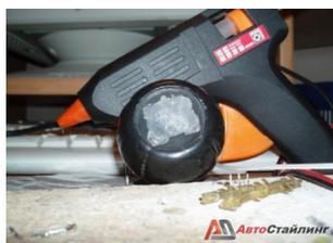
2) Печать производим в несколько слоев, желательно, чтобы материал, на котором вы все это делаете, не просвечивал. Готовим место для светодиода, делаем вертикальный срез в ручке для провода питания светодиода. К проводу желательно сразу прикрепить резистор. Свет лучше направить не в верх, а в сторону, в результате свечение должно получиться равномерным. Затем заливаем все клеем из пистолета. Заранее рассчитываем количество затрачиваемого клея, чтобы потом не пришлось стирать лишнее.
