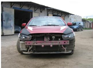
**2)** Отрезаем перекладину, но с запасом, чтобы ее остатки завернуть во внутрь. После отреза, монтажным феном нагреваем её и заворачиваем остатки.
