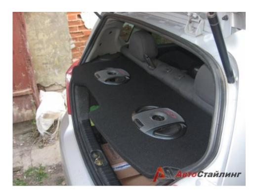
Для изготовления **акустической полки своими руками**, вам понадобится: - 1 лист фанеры 12мм. - 400руб. - саморезы по дереву и металлу - 100руб. - уголки для крепления стенок багажника.- бесплатно - карпет- 500руб. - скобы- бесплатно - картон. **Порядок наших**
