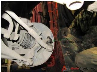
**5)** Но сначала – рулевые наконечники: вынимаем шплинт, откручиваем гайку, резким хлестким ударом молотка бьем по указанному ниже месту, и палец выпадает сам (продельываем с обеими сторонами):
