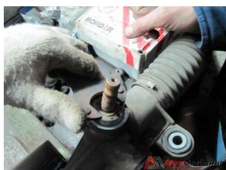
**9.5)** Выкручиваем прижимной стакан вала рейки.
