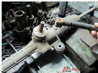
**9.3)** Снимаем промежуточный вал.
