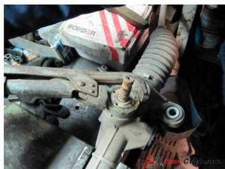
**9.4)** Откручиваем контргайку (использовали газовый ключ).
