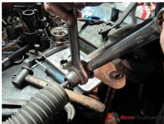
0 10) С помощью большого хомута и ключей на 29 и 22 ослабляем левую тягу от рейки с помощью ключей на 29 и 22.
