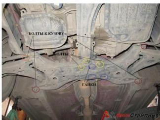
**6)** Откручиваем подрамник, 4 болта к кузову, 3 болта в районе задней подушки двигателя и 3 гайки там же.
