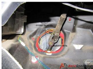
3) **ВАЖНО!** Колеса нужно поставить прямо, ключ из замка зажигания вытянуть, руль заблокировать. Это делается для того, чтобы предотвратить после снятия рейки проворачивание рулевого колеса на количество оборотов, большее, чем положено. В противном случае неизбежен обрыв проводов «улитки» подушки безопасности и появившаяся неисправность последней.
