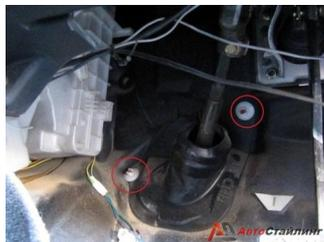
2) Выкручиваем болт, крепящий промежуточный вал к крестовине:
