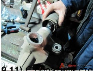
0 12) Вытаскиваем пыльник из рейки, откладываем в сторону.
