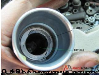
0 13) Снимаем резиновую прокладку с левого торца – видим алюминиевую прижимную шайбу, за ней
