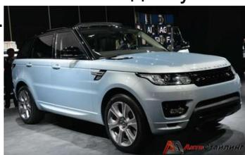
Основу силовой установки составляет турбированный дизель объемом 3 литра. Его мощность составляет 292 лошадиных сил и крутящий момент 600 н·м. Дополнительно установлен электромотор, который имеет мощность 35 кВт (эквивалент 48 лошадиных сил) и 170 н·м. Их общая мощность равна 340 «лошадей». Начиная с 1500 об/мин, достигается крутящий момент 700 н·м, что является лучшей характеристикой в классе. Если для Вас не хватает эти характеристик, то предлагаем сделать автотюнинг [ТУТ](#).
